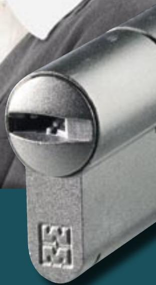
Champions® 48 è il cilindro di sicurezza a profilo europeo, certificato UNI EN 1303:05. Al suo interno lavora un doppio sistema di cifratura meccanico brevettato, protetto da dispositivi antigiraldello e rinforzi che contrastano le azioni di foratura, manipolazione ed estrazione forzata del cilindro.
