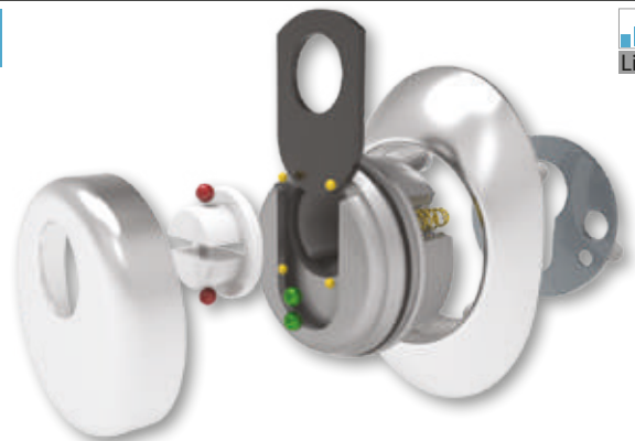
Sfere d'acciaio a protezione del corpo del cilindro e sulla rondella cromata + una piastra al manganese per una protezione totale
