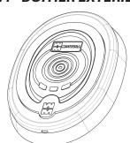
Le boîtier extérieur à TRANSPONDEUR prévoit un lecteur transpondeur (RFID), un avertisseur sonore et trois LED (rouge-jaune-verte); il contrôle la présence d'une clé transpondeur (TAG) à positionner le plus près possible de la zone de lecture située au centre du boîtier (zone A).
