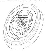
El embellecedor externo de TRANSPONDER cuenta con un lector transponder (RFID), un zumbador (buzzer) y tres leds (rojo, amarillo y verde); controla la presencia de una llave transponder (TAG) colocada lo más cerca posible a la zona de lectura, que está situada en el centro del embellecedor (zona A).
