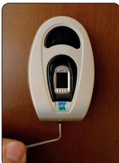
Montare la copertura metallica. Fissare il grano.
