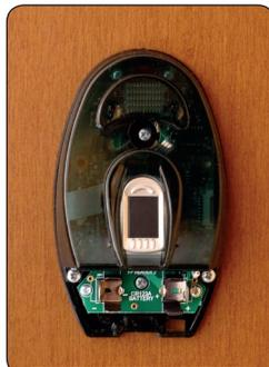
Fissare il lettore mediante le apposite viti/tasselli in dotazione.
