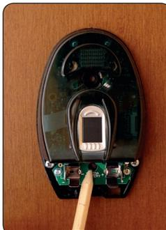
Posizionare il lettore sulla porta/muro, nella posizione desiderata, e segnare i punti di fissaggio.
