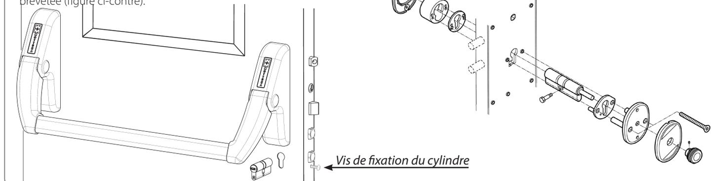
**N.B. En cas de version avec 1/2 cylindre, ce dernier devra être celui prévu pour les serrures de 30 mm d'épaisseur (C28B... - C30B... - C43B... - C48B...).**
